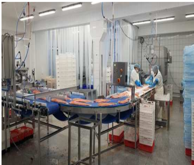
Fot. 3. Linia produkcyjna filetów z łososia
