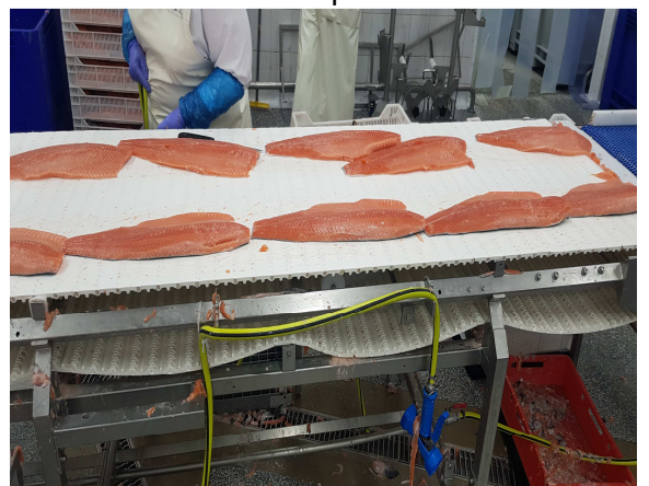
Fot. 6. Stanowisko doczyszczania filetów
