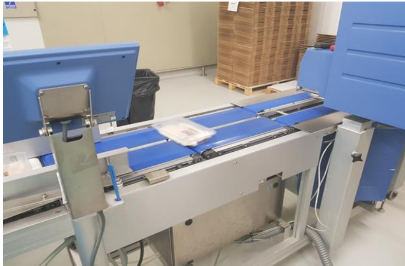
Fot.14. Etykietarka automatyczna, model: BIZERBA GLM-E50
