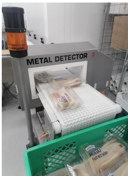
Fot. 8. Punkt kontrolny HACCP – wykrywanie metalu w produktach.
