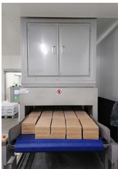
Fot. 10. Maszyna do rozmrażania ryb falami radiowymi.
