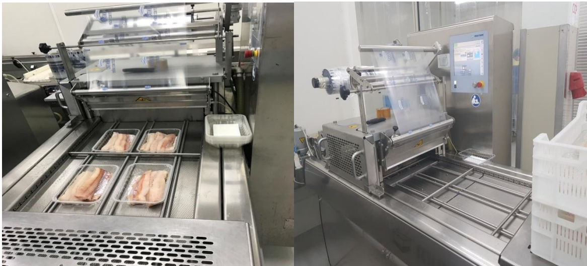
Fot.12. Multivac T300 Model: Traysealer.
